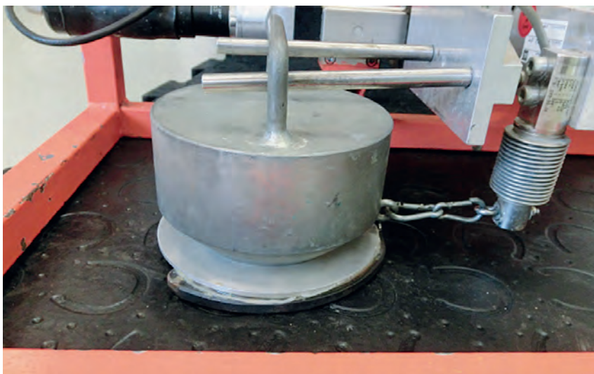
Bild 2: Rutschfestigkeitsmessung nass, mit Barhuf
