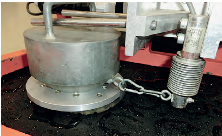
Bild 2: Rutschfestigkeitsmessung nass, mit Barhuf
